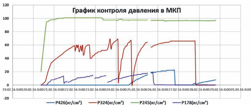
Рис. 1. Конструкция скважины и динамика давления в межколоном пространстве между 177.8 мм/244.5 мм, 244.5 мм/324 мм и 324 мм/426 мм.
